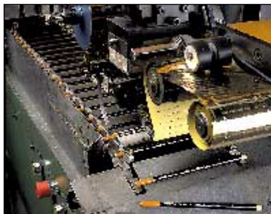
9. Het nummer wordt in de steel geslagen
