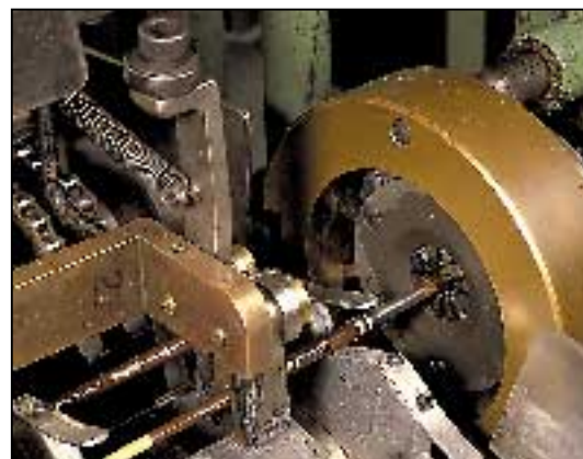
10. De steel wordt in de bus geschoven en vastgezet
